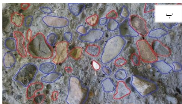
شکل ۱۰- نحوه‌ی شکست تیر شکافدار M2-NWC، (الف) مسیر شکست M2-NWC و (ب) سطح شکست M2-NWC (شکست از سنگدانه (قرمز) و شکست از ناحیه انتقال (آبی))
