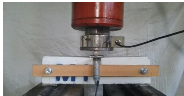
شکل ۷- تیرهای خمشی شکافدار در آزمایش خمش سه نقطه‌ای روش کار شکست
