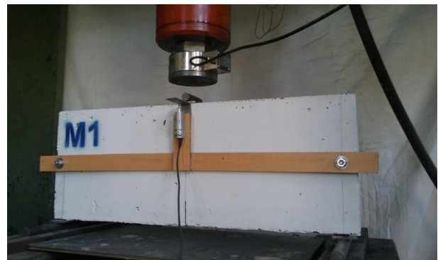
شکل ۱۴- نمونه‌ای از تیر شکافدار اثر اندازه مخلوط M1-LWAC با عمق ۲۸۰ میلی‌متر
