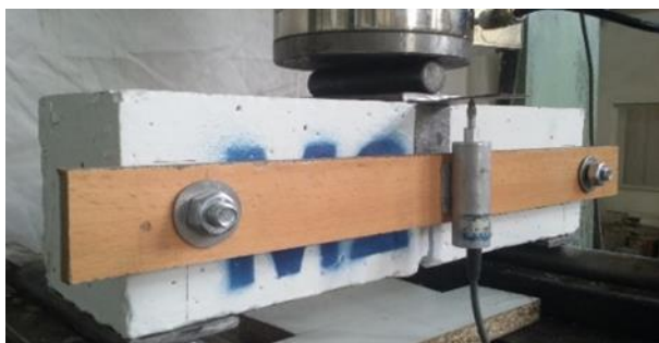
شکل ۷- تیرهای خمشی شکافدار در آزمایش خمش سه نقطه‌ای روش کار شکست
