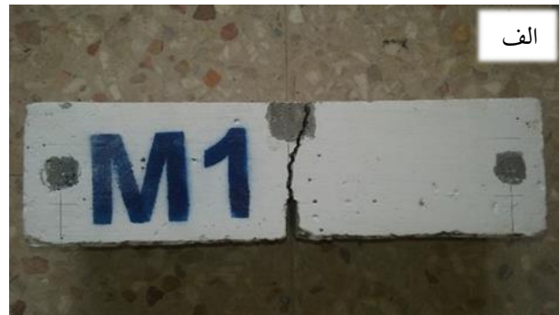
شکل ۹- نحوه‌ی شکست تیر شکافدار M1-LWAC، (الف) مسیر شکست M1-LWAC و (ب) سطح شکست M1-LWAC
