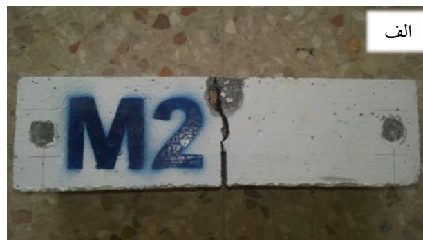
شکل ۱۰- نحوه‌ی شکست تیر شکافدار M2-NWC، (الف) مسیر شکست M2-NWC و (ب) سطح شکست M2-NWC (شکست از سنگدانه (قرمز) و شکست از ناحیه انتقال (آبی))
